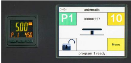
电子气压表, 可防止机器在运行过程中发生故障
