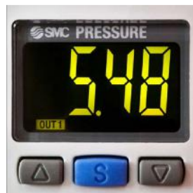
电子气压表, 可防止机器在运行过程中发生故障
