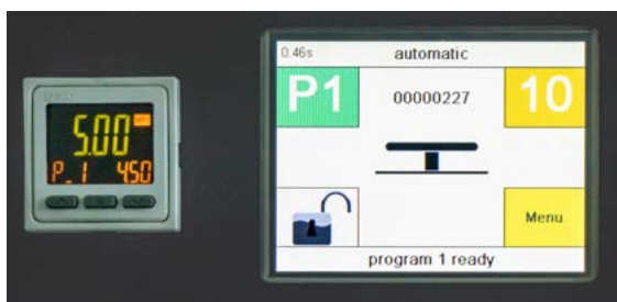
Manómetro digital para evitar disfunciones de la máquina
